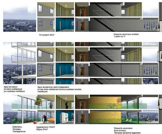
Obr. 4 Štúdia obnovy obvodového plášťa, ktorá výrazne mení charakter aj dispozíciu bytového domu, Lacaton, Vassal, Druot.
