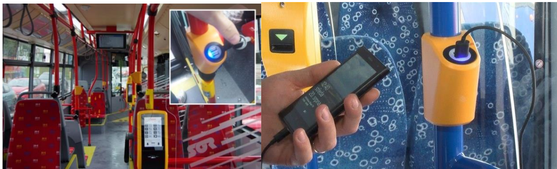
Obr. 2.5.11 Príklad na umiestnenie nabíjačiek mobilov vo vozidlách MHD (vľavo v MHD Bratislava) Zdroj: https://zn.sk/MHD-nabijanie-cez-usb-bratislava/ a batteryshop.sk
