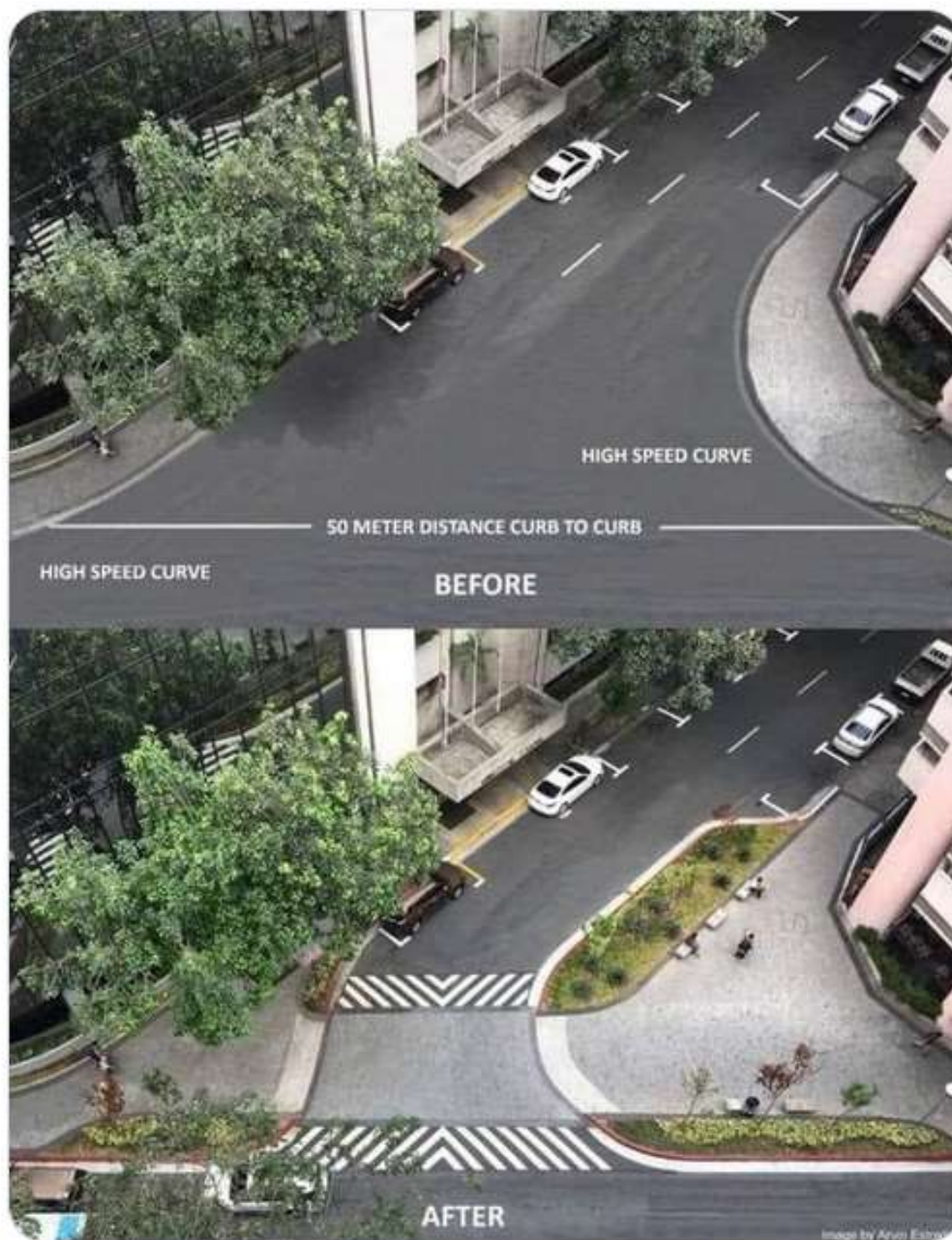
Obr. 5.1.6 Úprava ulice s upokojuvacími prvkami
