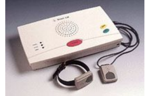
Monitorovanie a signalizácia potreby pomoci - signalizačné zariadenie
